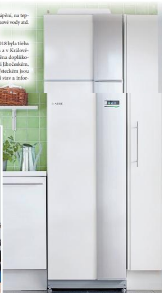
Ventilační tepelné čerpadlo je systém na recyklaci energie. Odebírá energii teplému vnitřnímu vzduchu, který je odváděn z domova ventilací, a používá ji k vytápění a k ohřevu čerstvého přiváděného vzduchu a teple vody. Nibe F730 je též připraveno pro bivalentní vytápěcí režim v kombinaci s olejovým nebo plynovým kotlem. nibe.com
