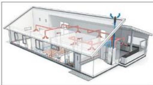
▲ Obr. 3 ● Schéma rovnotlakového větrání v rodinném domě [4]
