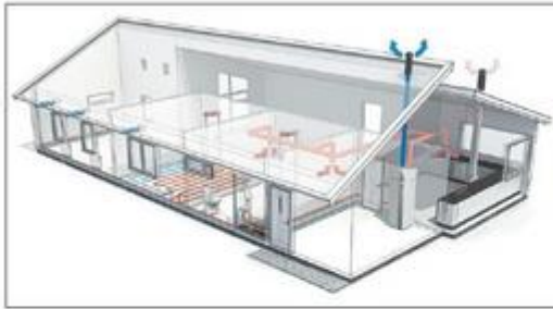
▲ Obr. 2 ● Schéma podtlakového větrání v rodinném domě [4]
