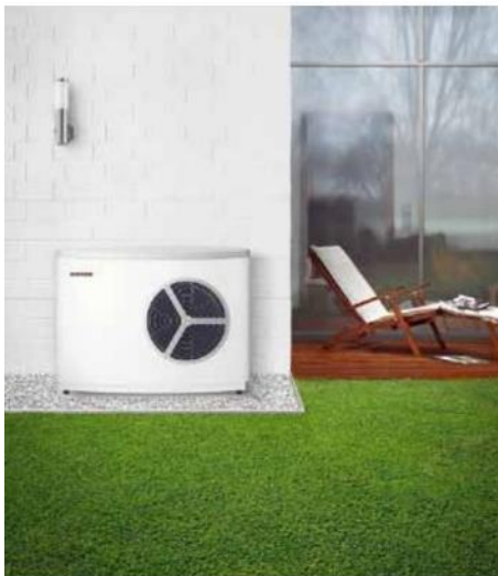
Tepelné čerpadlo Logatherm WPL 6 AR TS184 COMFORT systému vzduch/voda, výkon 6 kW, topí i chladí a je vybaveno integrovaným zásobníkem o objemu 184 litrů (BUDERUS)
