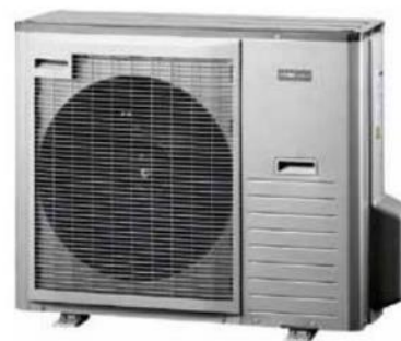
Venkovní jednotka tepelného čerpadla AMS 10-8 systému vzduch/voda. Čerpadlo pracuje až do venkovní teploty -20 °C, v případě potřeby dokáže dům nejen vytápět, ale i chladit (NIBE)
