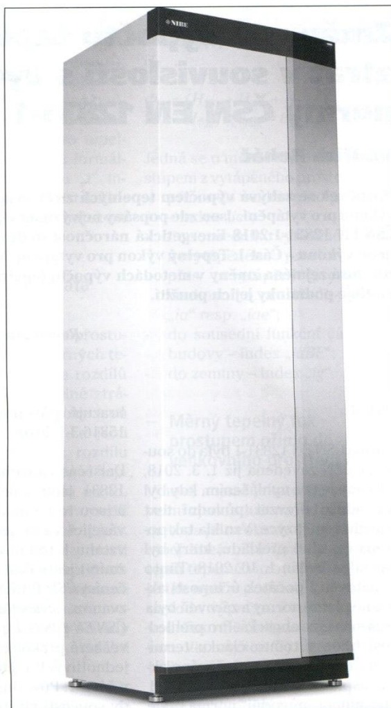
▲ Obr. 3 ● Nová vnitřní systémová jednotka NIBE VVM S320 je kompatibilní se všemi tepelnými čerpadly NIBE systému vzduch-voda. Součástí je nerezový zásobník TV o objemu 180 l, záložní elektrokotel s výkonem 9 kW, pojistné a zabezpečovací zařízení a kompletní regulace s dotykovým displejem pro snadné ovládání
